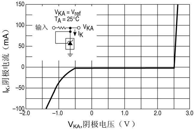
图 5. 阴极电流和阴极电压关系曲线
