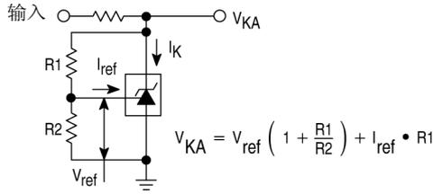
图 3.  $I_{off}$  的测试电路
