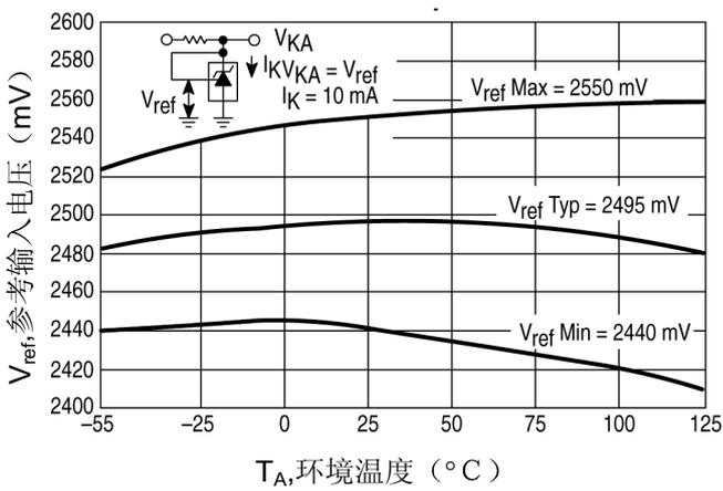
图 7. 参考输入电流和环境温度关系曲线
