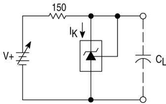
图 17. 稳定性边界条件曲线 B,C 和 D 的测试电路
