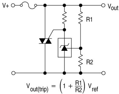
图 25. 可控硅灭弧电路
