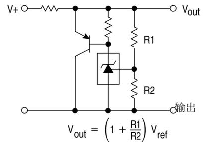
图 20. 三端固定稳压器的输出控制
