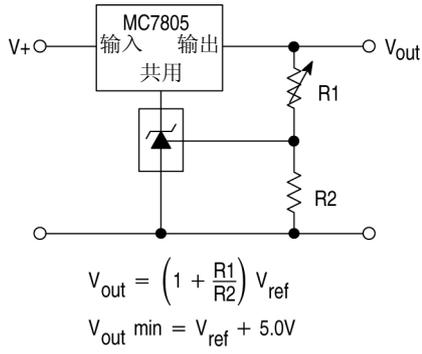
图 21. 串联稳压器
