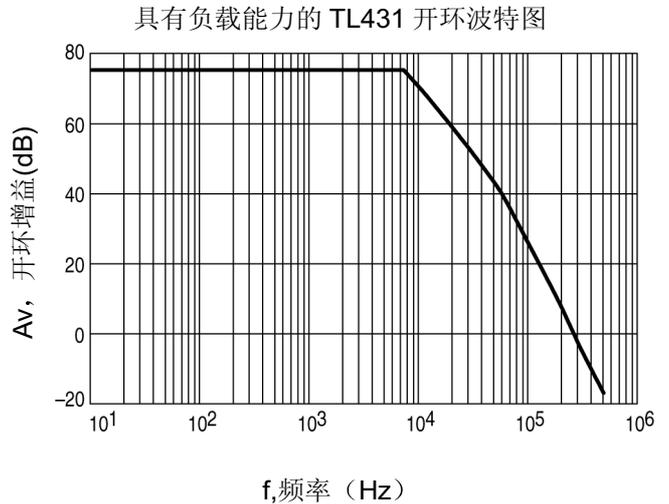
具有三个极点, 此系统不稳定。稳定此电路的唯一希望是加入一个零点。然而这只能通过输出电容上加一个串联电阻来实现, 而这会降低它作为一个噪声滤波器的功效。因而在实际的参考电压应用中, 最佳解决方案是在低噪声应用中使用更小值的电容或使用一个很大电容值以提供噪声滤波和系统的一个主要极点下降。
