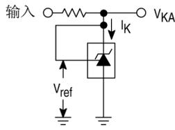
图 2.  $V_{KA}>V_{ref}$  的测试电路
