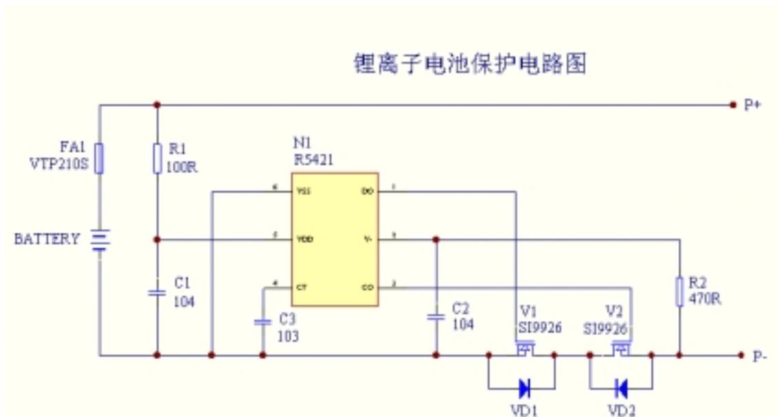
如上图所示，该保护回路由两个 MOSFET (V1、V2) 和一个控制 IC (N1) 外加一些阻容元件构成。控制 IC 负责监测电池电压与回路电流，并控制两个 MOSFET 的栅极，MOSFET 在电路中起开关作用，分别控制着充电回路与放电回路的导通与关断，C3 为延时电容，该电路具有过充电保护、过放电保护、过电流保护与短路保护功能，其工作原理分析如下：
