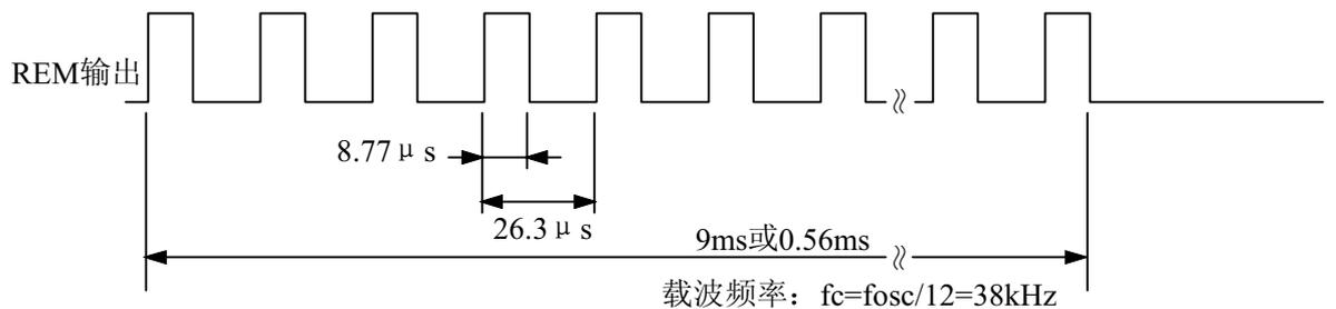
说明：如果按键一直按着，第二个和其后的时间内，仅发射引导码和停止位，将使远红外二极管处于节能状态。
