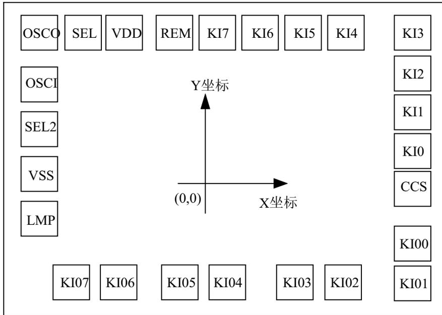
建议衬底接 V<sub>SS</sub>，在载片岛面积为 1.44mm×1.127mm。
