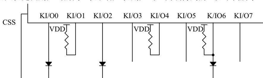
KI/On 接上上拉电阻，低 8 位用户码'相应位为“1”。如上图所示键盘的外接方式对应选择码为：
