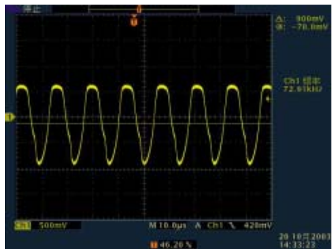
图 5 直流电源供电时预热状态时的 V_{BE}
