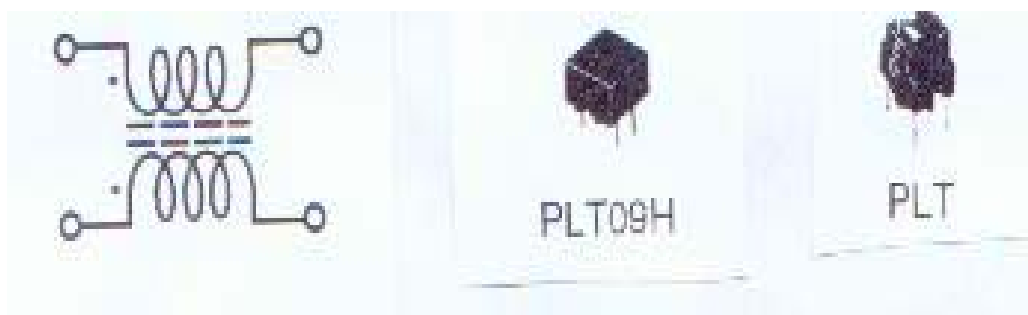
图 8 共模扼流圈及其等效电路
