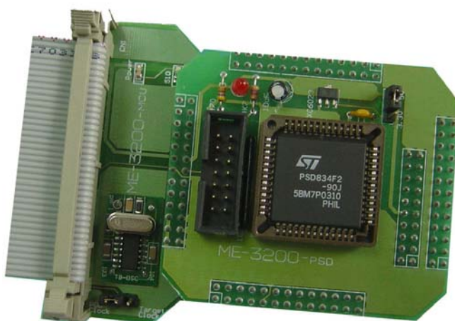
图 3: ME-3200 仿真头组件的 PSD 模块
