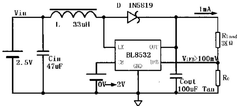
(9) 测试 CE 端低电平电平
