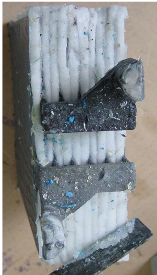
采用玻璃纤维隔板的中国AGM“胶体”电池
