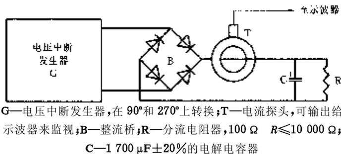
图 A1 确定短时中断发生器冲击电流驱动能力的电路
