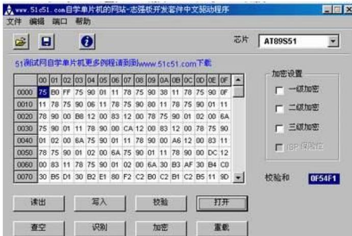
我们以烧写配用的 AT89S51 为例说明使用方法.假定要写入的文件是”test.hex”.首先,连接编程器到计算机并口,然后连接电源.编程器指示灯亮,将 89S51 插入 ZIF 插座,锁紧手柄.然后启动软件,鼠标单击在右边的”芯片”下拉框,选择好芯片类型,这里选”89S51”.在”文件”菜单选择”打开 Hex 文件”,找到”test.hex”文件,单击”打开”.窗口中显示文件内容,右下角显示校验和.单击”写芯片”按钮,编程器烧写指示灯亮,烧写完毕报告结果,写入之前会自动擦除芯片内容,写入完毕会自动校验.如果是需要加密,可以选择加密级别.如烧写 2051,4051 等芯片,则芯片插入中间较小的烧写卡座.
