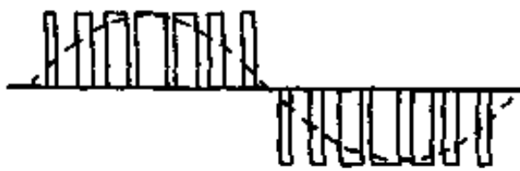
图 2-12 正弦波脉宽调制波形
