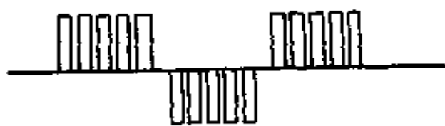
图 2-10 矩形脉宽调制波形
