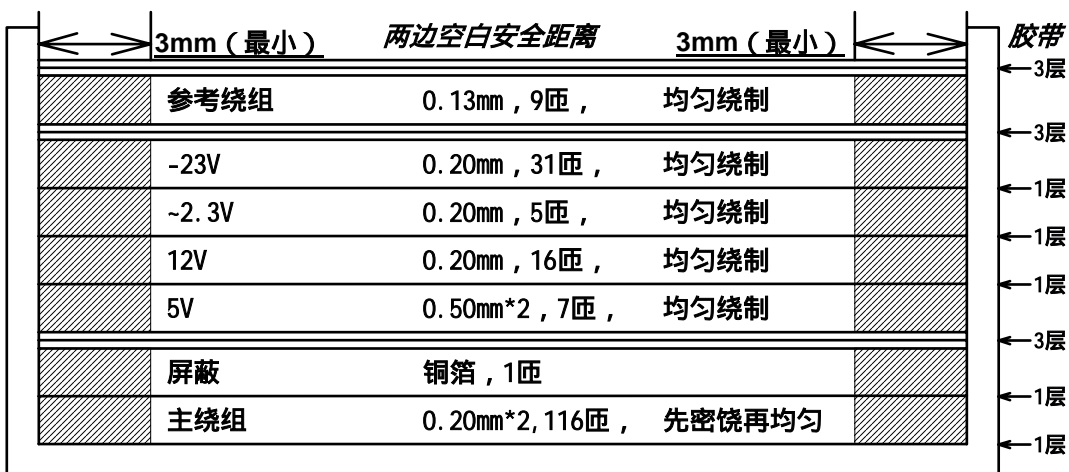
图 5、例 2, T1, EEL19, 1mH 变压器结构
