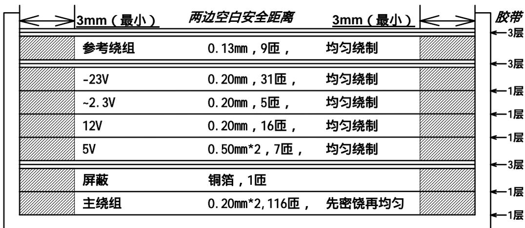
图 5、例 2, T1,EEL19,1mH 变压器结构
