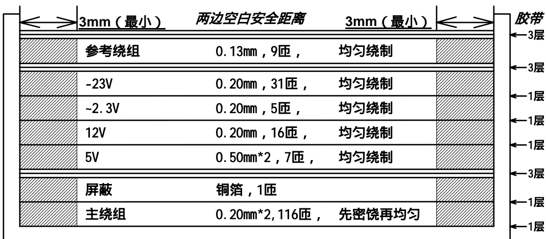
图 5、例 2, T1, EEL19, 1mH 变压器结构
