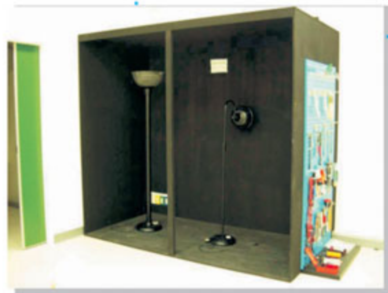
燈具產品專用的測試箱 (法規IEC/EN 60598)
