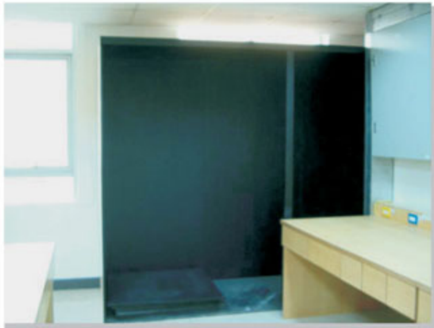
家電產品專用的測試箱 (法規: IEC/EN 60335)
