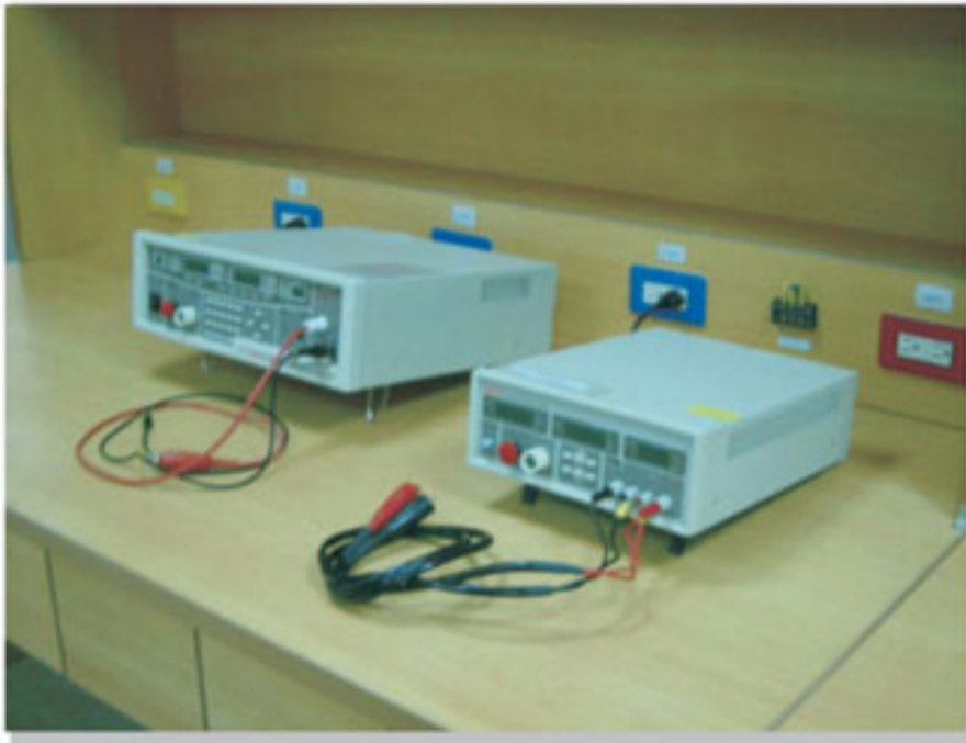
適用於任何標準的耐壓測試壓機，接地測試機， 絕緣阻抗機 (法規: IEC/EN/UL 60950, 60065... etc)
