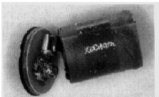
图5 电化学导致开路失效样品形貌
