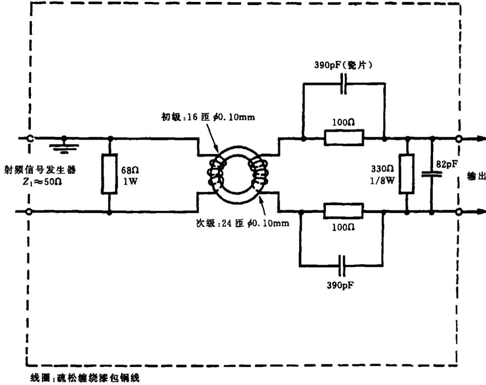
图 A2a) 平衡/不平衡转换器电路
