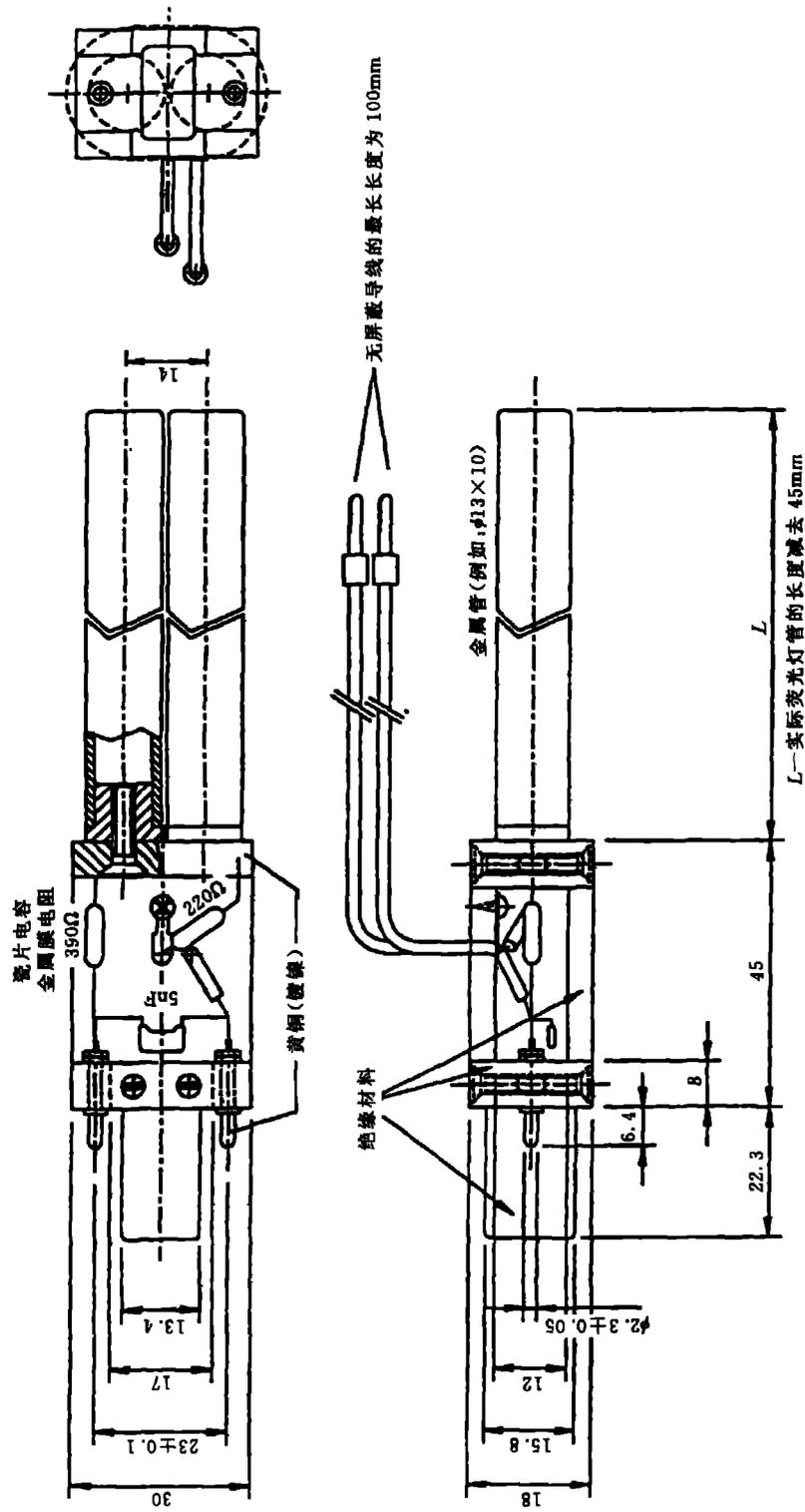
图 4e) 管径 12 mm 的直管形, 双管单端荧光灯的模拟灯
