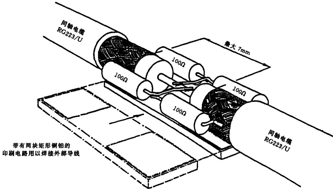
图 B3 大环形天线用槽的结构实例
