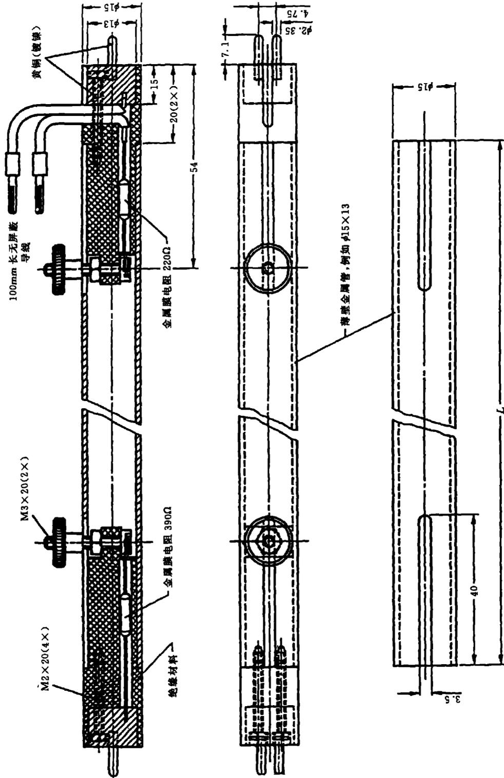
L—实际荧光灯管的长度减去 40 mm
