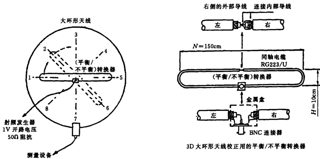
图 B4 校验大环形天线的试验布置
