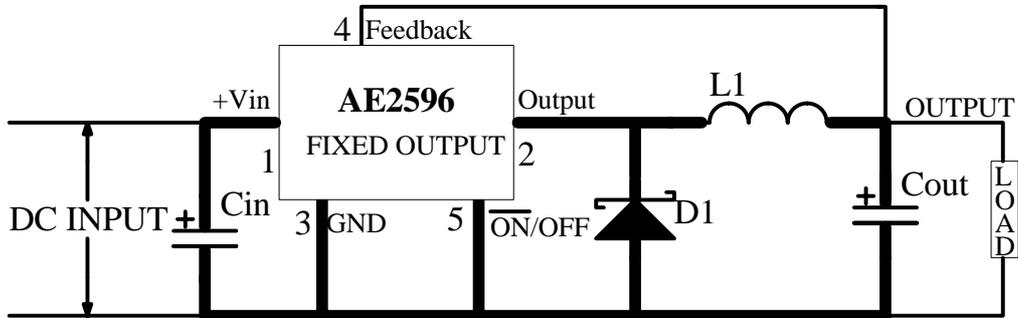
$C_{IN}$  —470  $\mu$ F 50V       $C_{OUT}$  —220  $\mu$ F 25V (Ni chi con PL 系列铝电解电容)
