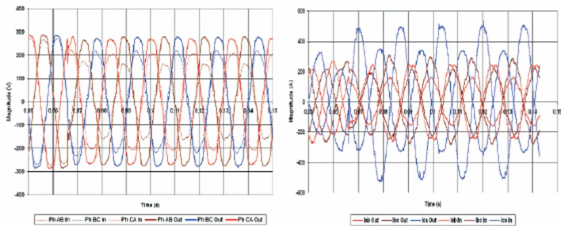
图 6. 电压突降低至 70% 名义值时电压波形 (左) 和电流波形 (右)
