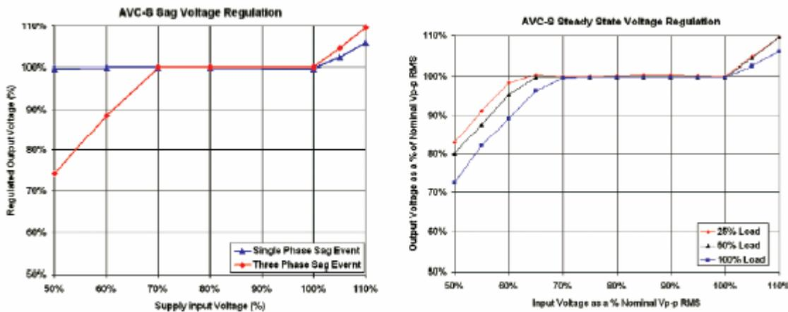
图 9. AVC 的电压突降（左）和稳态电压（右）调节特性
