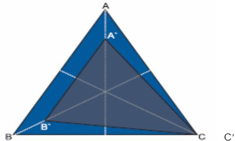
图 5、三相电压突降矢量图（三角图）
