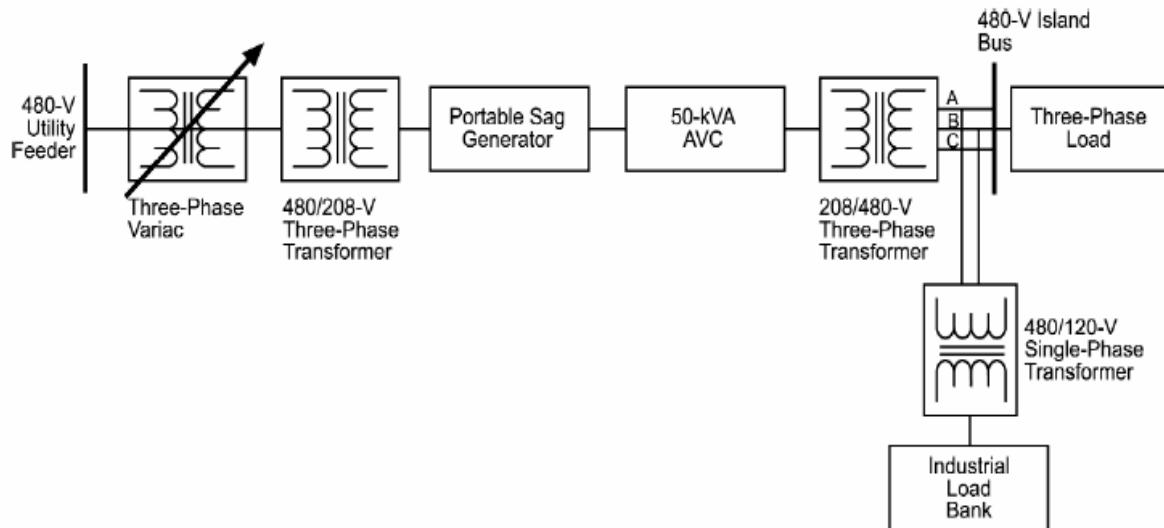
图 3. 电压突降测试安装图
