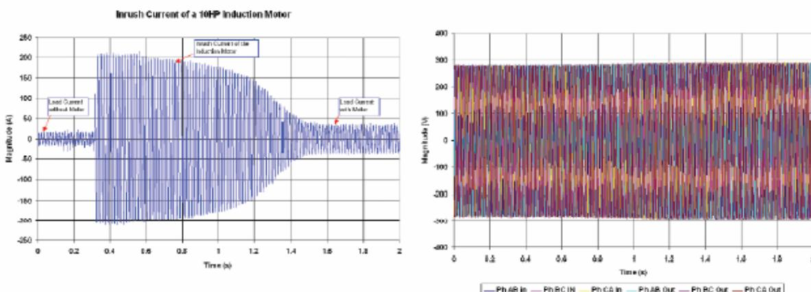
图 10. AVC 接有一 10 马力电动机的浪涌电流（左）和相应电压的波形（右）
