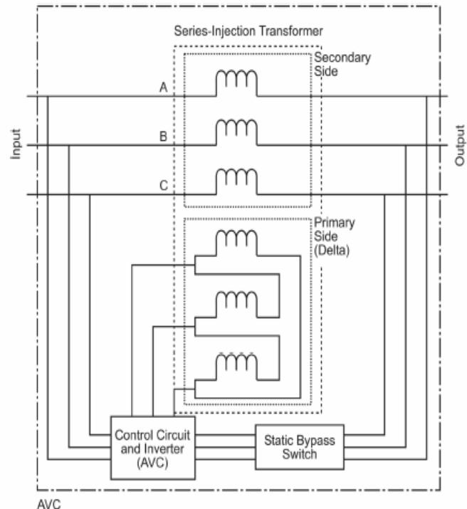
图 2. 串联注入变压器连接图
