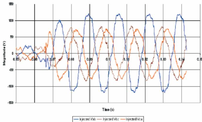
图 7. 在 AVC 上由串联注入变压器所提供的校正电压
