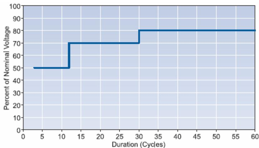
图 4、SEMI F47 标准的幅度-持续时间免疫曲线
