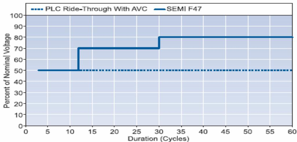
图 11. SEMI F47 和受 AVC 保护的 PLC 的跨越曲线
