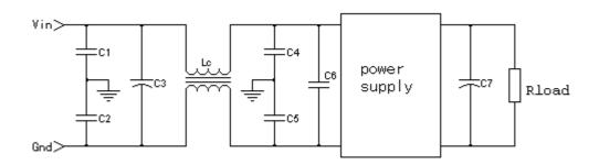
该电路主要对输入进行滤波,削弱对稳压电源或电子镇流器的输入的传导干扰。其中,C1、C2和C4、C5及Lc用于滤除共模噪声,C3和C6用于滤除差模噪声。输出端一般接一电解电容,负载电流大时还需接高频电容,用于消除负载端对输入的噪声干扰。C1=C2、C4=C5、C3=C6,Lc=(7~30)mH、磁材使用铁氧体材料。
