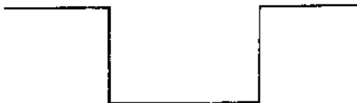
图 5-9 G<sub>6</sub> 第 10、4、6 脚对地波形
