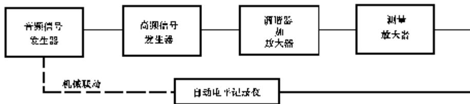
图 20 电压频率响应测试电路
