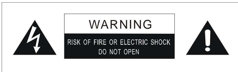
辅助性标识与两个图形符号(等边三角形内的带箭头闪电符号,及等边三角形内的惊叹号)的组合,应至少位于器具的一个外表面,见SA22.3。上述例子为一种排列方式-将两个符号分别放于辅助标识的两边。其它合格的排列方式有:两个在同一边;一个在上面,另一个在下面;两个都在上面;两个都在下面;或向用户说明相同信息的其它排列方式。
