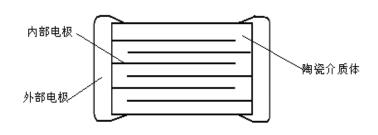
在这种"多层"结构中,由于多层电极的平行排列以及在相对电极间的介质层非常薄,电极面积 A 得以大大增加,因此电容量 C 会随着因子 N (介质层数)的增加和介质层厚度 t'的减小而增大。这里 A'指的是交迭电极的重合面积。
