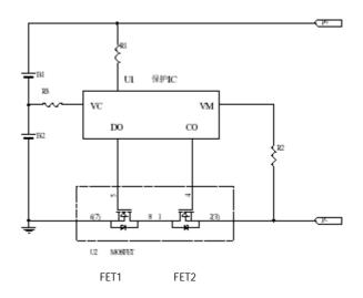
注: U1 为保护板保护 I C (D0 为放电保护控制端, C0 为充电保护控制端), U2 为 MOSFET 管保护回路主要由保护 I C 和两个 MOSFET 管构成, 保护 I C 同时检测电池 B1、B2 两端电压并控制两个 MOSFET 管的通断。
