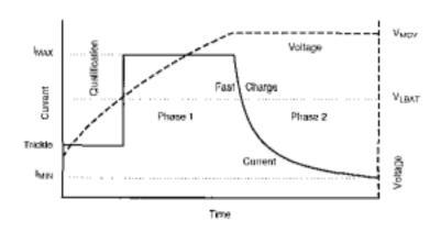
充电过程主要由恒流和恒压两阶段构成,线路中采用的芯片主要是对充电电流和充电电压及转灯指示进行控制,以完成整个充电过程.
