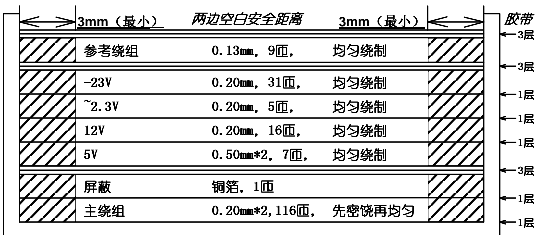
图 5、例 2，T1,EEL19,1mH 变压器结构
