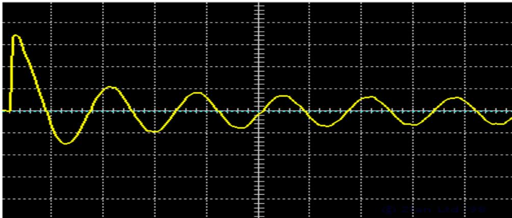
2, 1KW 调光灯启动波形：（导通角 100%）
