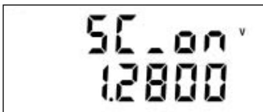
此步驟用於設定 Von 的參數。當待測物的輸出達到 Von 電壓時，電子負載開始拉載電流，而此時該 Von 參數即是開始拉載的電壓電位。
