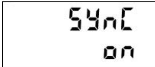
負載模組可設定成在同步化的模式中與其他模組一齊運作。同步化可在相同的組合平台裏，或不同的組合平台裏應用到模組上。
