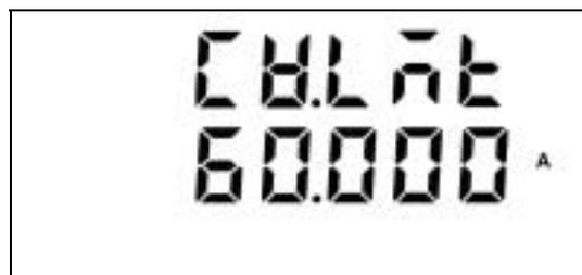
此為設定 CV 模式中的拉載限定電流。一旦設定好便是負載模組於 CV 模式中所能拉載的最大電流。
