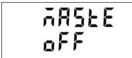
在同步化模式的運作下，可將負載模組設定為模組中的主控模組或從屬模組。若在主控模組上按下 **SPEC**，**NOISE**，**WATT**，或 **LOAD** 中的任何一個鍵，此鍵將同時觸發其他的負載模組，因而其他的負載模組也會運作，就好像同一個鍵在同一時候被按下一樣。
