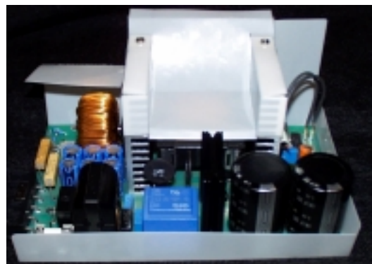
Abb. 22 Ausführung der Isolation- und Luftleitfolien
