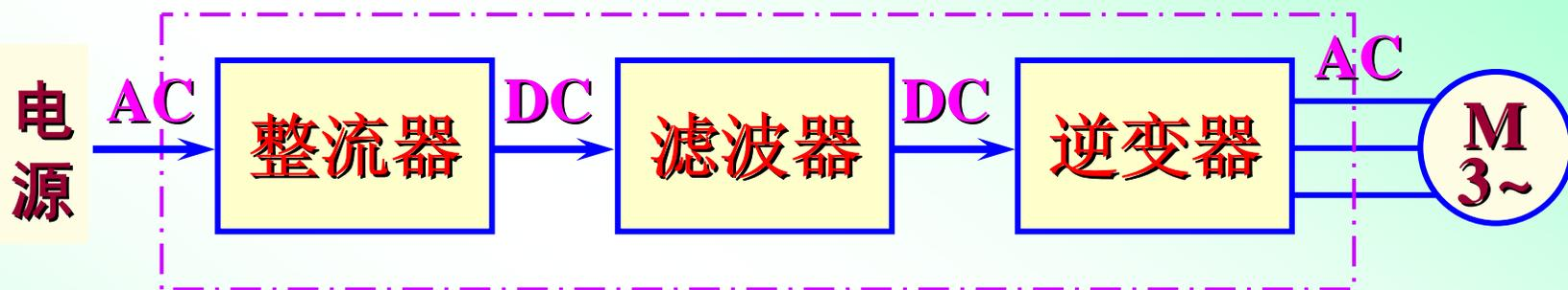
主电路 — 为电动机提供调频调压电源的电力变换部分。
