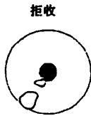
图 2071-3 超过玻璃密封区 1/3 的气泡
