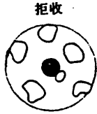
图 2071-1 超过引出端至外壳距 高一半的径向裂纹
