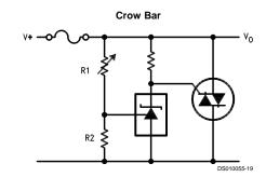
$$V_{LIMIT} \approx \left(1 + \frac{R1}{R2}\right) V_{REF}$$
