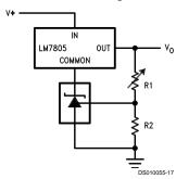
$$V_{O} = \left(1 + \frac{R1}{R2}\right) V_{REF}$$
