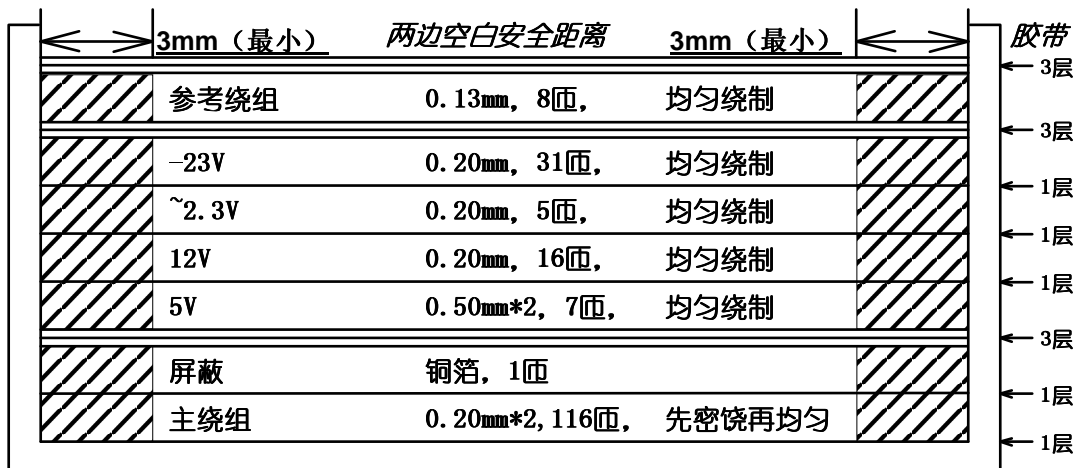
图 5、例 2，T1, EEL19, 1mH 变压器结构
