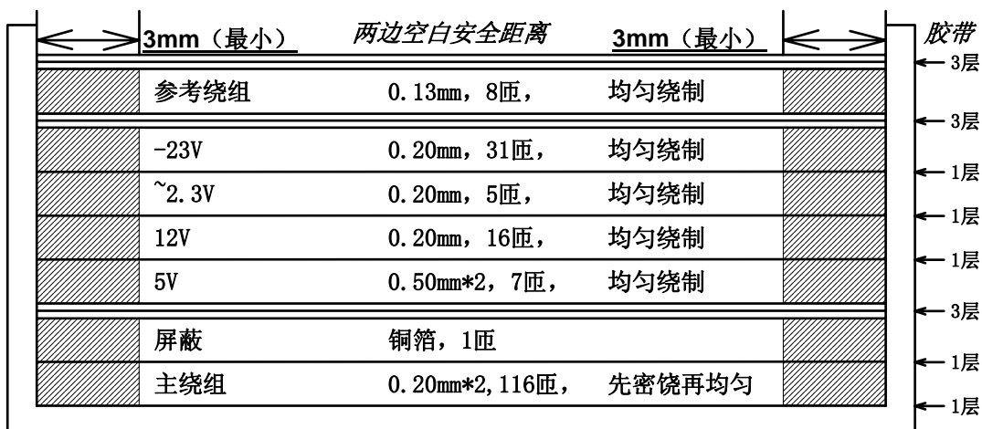
图 5、例 2, T1,EEL19,1mH 变压器结构
