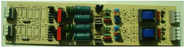
B: 一级电源 PPFC 一拖二系列结构,欧洲标准兼容 CCC 标准,适用灯管 T5/T8/PL 系列 光源,功率范围 28W~72W
