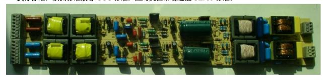
D: 二级电源 APFC 一拖一系列结构,适用灯管 T5/T8/PL 系列光源,功率范围 28W~55W 执行标准: 欧洲标准兼容 CCC 标准,应对美国市场适配 UL935 标准。
