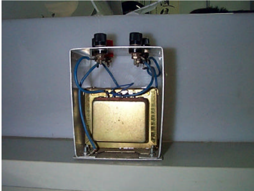
Fig. 4.12 變壓器之外觀
