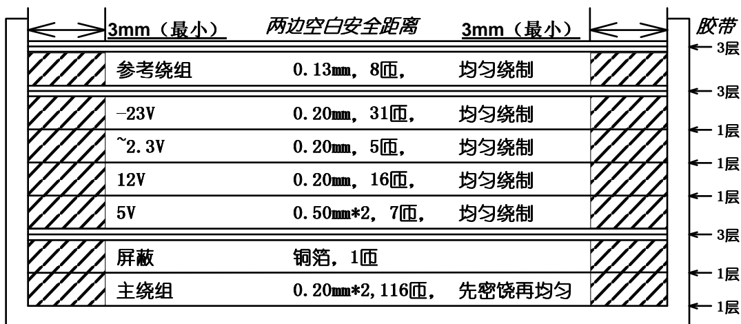
图 5、例 2, T1,EEL19,1mH 变压器结构
