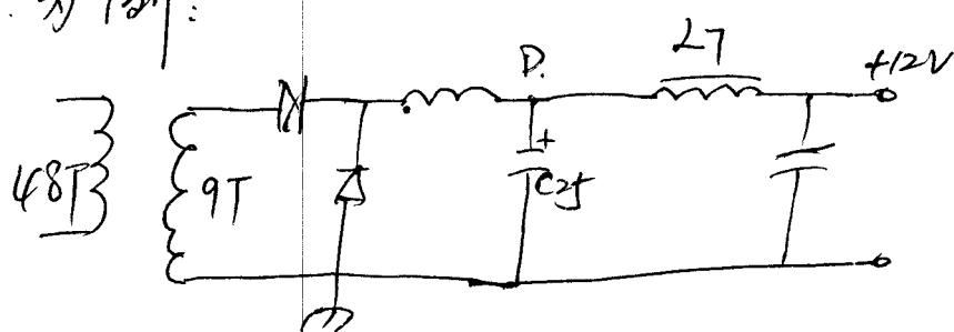
$$D. C_0 \geq \frac{T_s^2 \times V_o}{8L_0 \times \Delta V_o}$$
