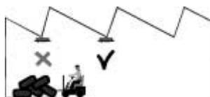
图 22 传感器应安装在有持续反射特性的区域上方
