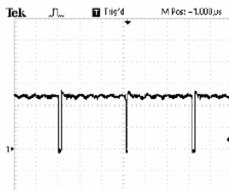
交流 220VAC, SW 脚电压波形
