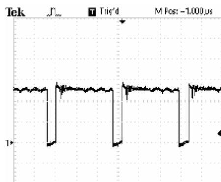
交流 220VAC, SW 脚电压波形
