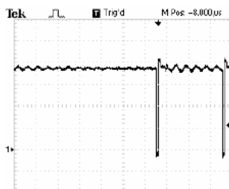
交流 220VAC， SW 脚电压波形
