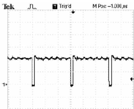
交流 110VAC, SW 脚电压波形
