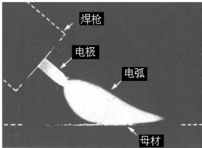
(钨电极, 直径2.4mm, 正极性, 150A)
