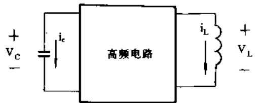
图 27 一般开关变换器的结构图
