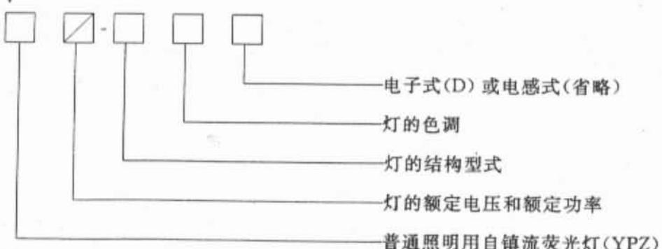
示例：220 V 13 W 3U 型冷白色普通照明用电子式自镇流荧光灯的型号为：
