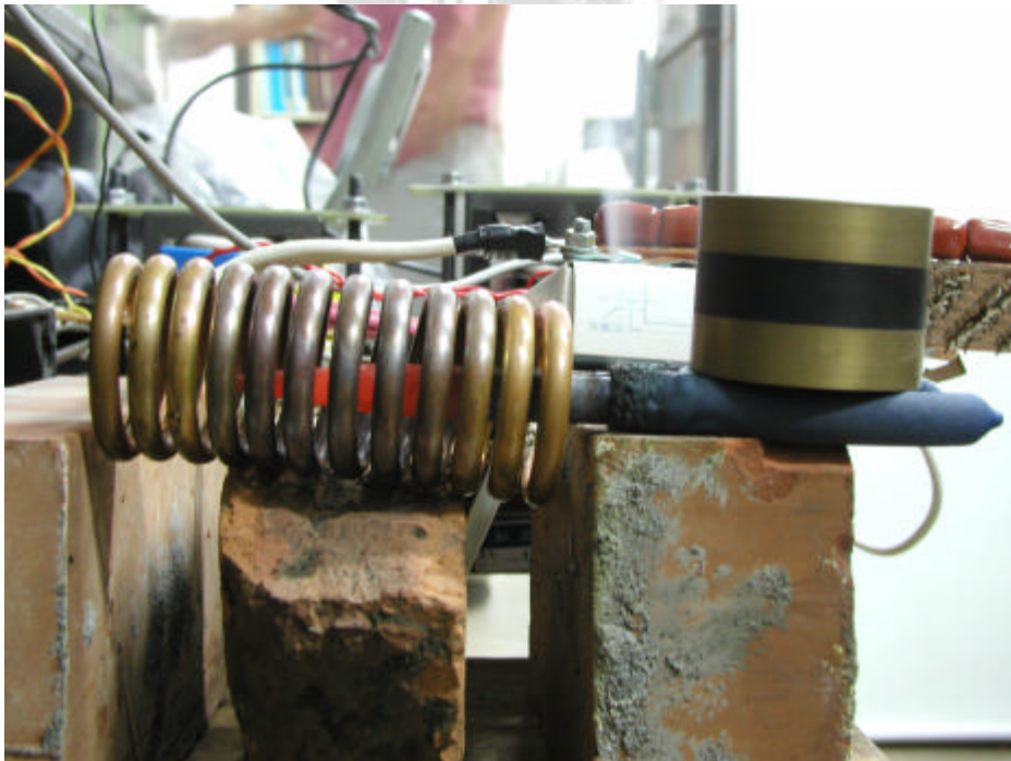
圖5.36 加熱線圈與加工物件實體圖
