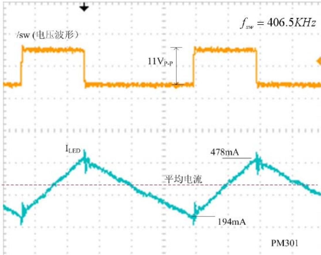
图 4: PM301 恒流源模块  $V_{SW}$ 、 $I_{LED}$  信号实测波形
