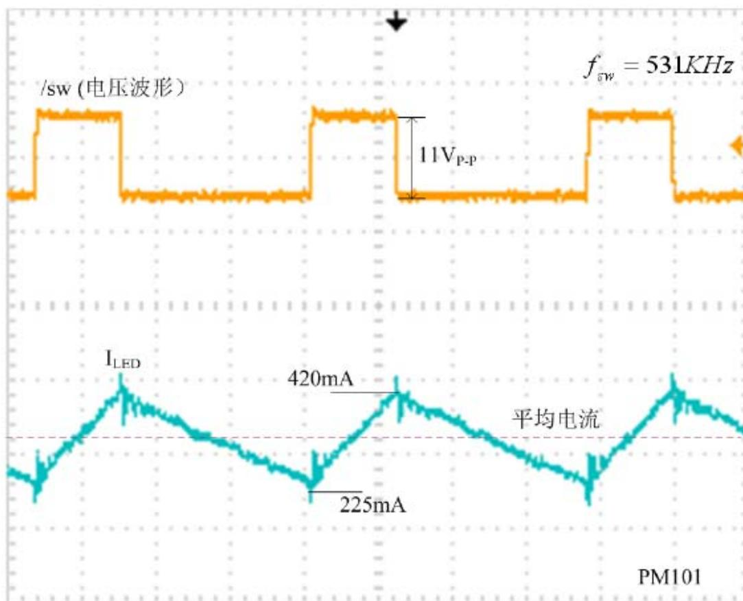
图 3: PM101 恒流源模块  $V_{sw}$ 、 $I_{LED}$  信号实测波形
