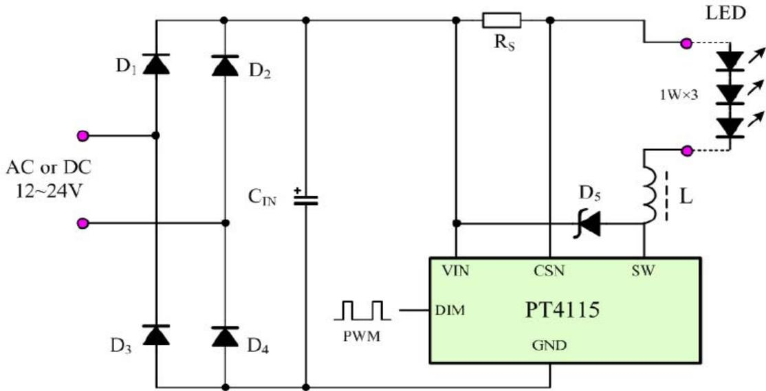
图 2：PT4115 驱动 3 颗 1W 白光 LED 的电原理图
