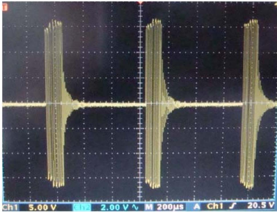
图 7：电子变压器输出的交流波形
