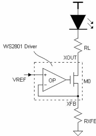
Fig4, 恒定电流驱动模式的电路
