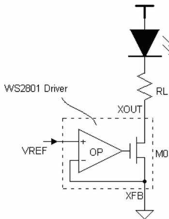
Fig5, 恒定电压驱动模式电路示意图
