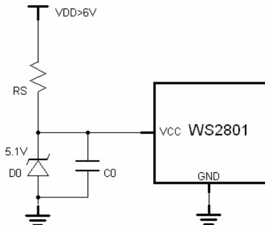
Fig 3, 当输入电压高于 6V 时候，WS2801 的电源设置
