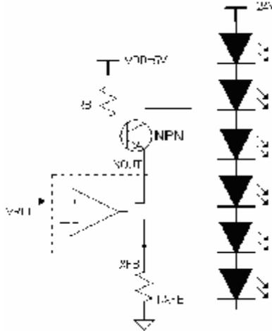
Fig7, 利用外部开关实现 LED 的恒定电流驱动
