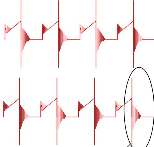
开关管源极限流电阻检测波形.开关管关断后都会有一个较大的电流尖峰,这尖峰是怎么形成的呢?
