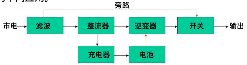
黑线是市电输入正常时的路径,红线是市电故障时的路径,蓝线为旁路时的路径
