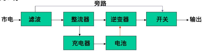
黑线是市电输入正常时的路径,红线是市电故障时的路径,蓝线为旁路时的路径 正常运行方式
