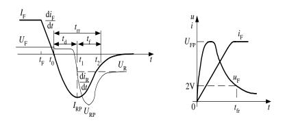
二极管反向恢复时电流电压波形 二极管正向导通电流电压波形
