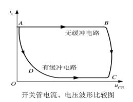
从电磁兼容性设计角度考虑,应尽量降低开关管 V2、V3的开关频率,从而降低 di/dt、dv/dt 值。另外使用 ZCS或 ZVS软开关变换技术能有效降低高频逆变回路的电磁干扰。在大电流或高电压下的快速开关动作是产生电磁噪声的根本,因此尽可能选用产生电磁噪声
