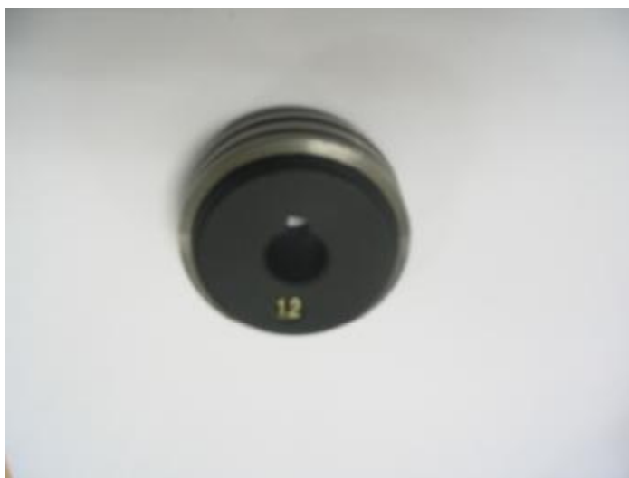
PWF-2送丝机的送丝轮使用外侧丝槽
