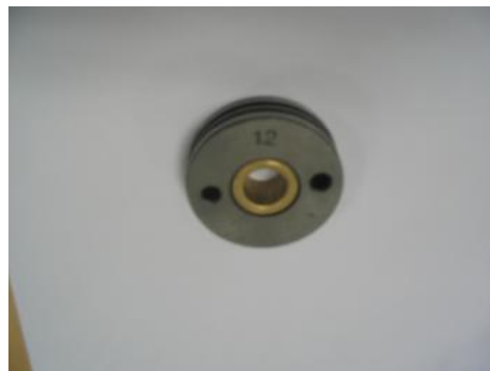
PWF-4送丝机的送丝轮使用内侧丝槽
